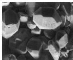
Baterie după 2 ani, neutilizată, încărcată, fără impulsuri Structură tip burete Cristale groase de sulfat
